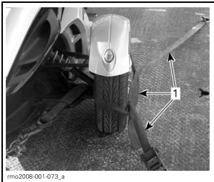
TYPIQUE - ARRIMAGE DES ROUES AVANT — MÉTHODE 2
