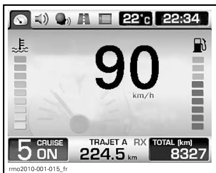
VUE DE L'ÉCRAN DE CONDUITE PAR DÉFAUT
