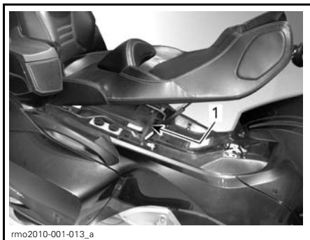
1. Boîte à fusibles située sous le siège
