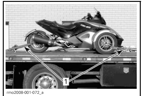
TYPIQUE 1. Roues avant et arrière solidement arrimées à la semi-remorque
